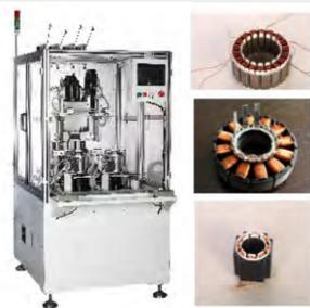
无刷电机/步进电机专用绕线机
