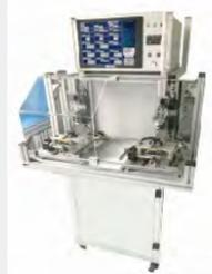
无刷电机反电势综合测试装置
