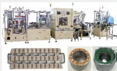
小功率伺服电机定子全自动生产线
