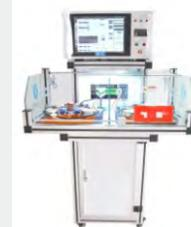
无刷电机定子综合测试装置
