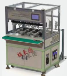
全自动无刷电机内绕线机
