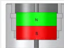
音圈电机磁组件
