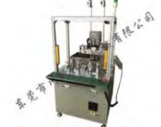
**无刷电机全自动内外绕线机 (凸轮)**
