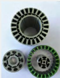
电机定转子铁芯冲压
